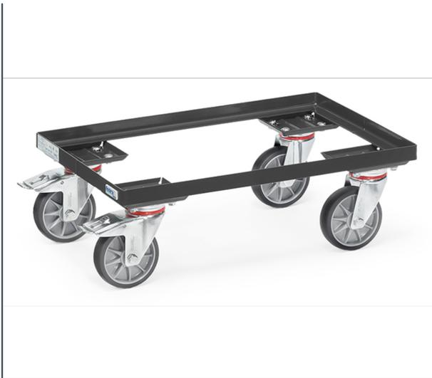
Eurokasten-Roller in offener Winkelstahlkonstruktion, pulverbeschichtet anthrazitgrau RAL 7016. Mit 4 Lenkrollen mit TPE-Bereifung, Naben mit Rillenkugellager. 2 Stück mit Feststeller, gemäß der Europäischen Norm EN 1757-3 (Sicherheit von Plattformwagen). Passend für Eurokästen 600 x 400 mm.
