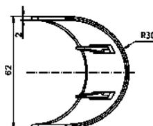
Radiusersatz auf Kabelhalter angeklippt
