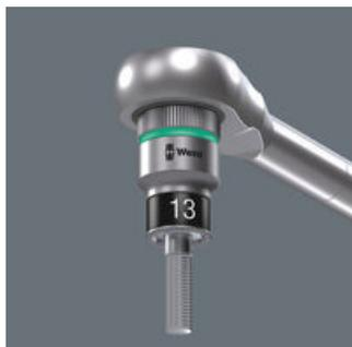
Die Klemmung der Außensechskant-Schraube im Steckschlüsseleinsatz wird durch zwei federnde Kugeln und einen dauerelastischen hochfesten Schrumpfschlauch gewährleistet. Dieser wird durch einen vorderen Stahlbund wirksam gegen mechanische Verletzungen geschützt. Besonders hilfreich in schwer zugänglichen Arbeitsbereichen, wo man die zweite Hand nicht zum Festhalten der Schraube nutzen kann.
