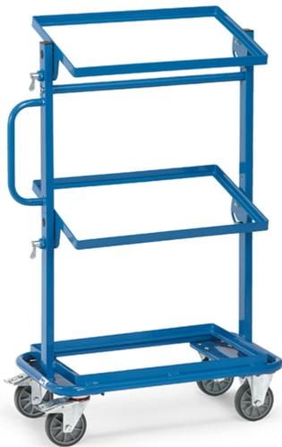
Stahlrohr- und Profilstahl-Konstruktion, pulverbeschichtet, blau RAL 5007. 3 offene Rahmen, ohne Platte. Obere und mittlere Etagen nach beiden Seiten um 15° und 30° neigbar. Arretierung mittels Federriegel. 2 Lenk- und 2 Bockrollen, TPE-Bereifung, Naben mit Rillenkugellager. Feststeller an den Lenkrollen, gemäß der Europäischen Norm EN 1757-3 (Sicherheit von Plattformwagen). Tragkraft obere und mittlere Ladefläche 50 kg.
