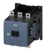
Leistungsschütz, AC-3 400 A, 200 kW / 400 V ohne Spule Hilfskontakte 2 NO + 2 NC 3-polig, Baugröße S12 Hauptleiter: Schienenanschlüsse Antrieb: konventionell Hilfsleiter: Schraubanschlüsse
