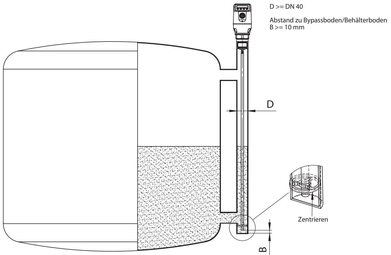
Einbau in einen metallischen Behälter
