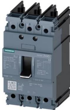
Leistungsschalter 3VA5 UL Frame 125 Schaltvermögenklasse S 25kA @ 480V 3-polig, Anlagenschutz TM210, FTFM, In=80A Überlastschutz Ir=80A fest eingestellt Kurzschlusschutz Ii=10 x In ohne Anschluss
