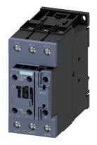
Leistungsschütz, AC-3e/AC-3, 65 A, 30 kW / 400 V, 3-polig, DC 24 V, 0,8-1,2\* US, mit integriertem Varistor, Hilfskontakte: 1 S + 1 Ö, Schraubanschluss, Baugröße: S2, geeignet für SPS-Ausgänge
