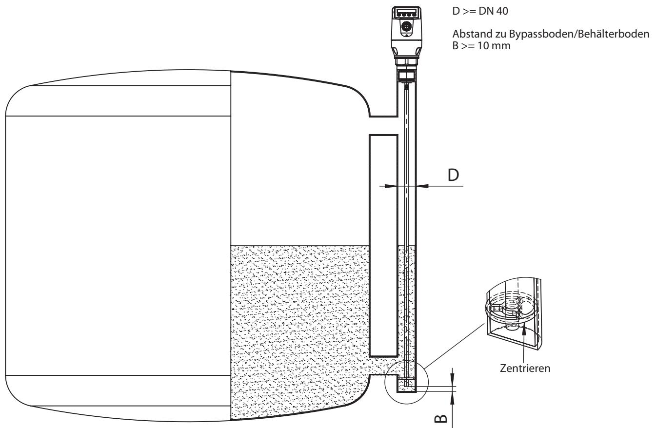
Einbau in einen metallischen Behälter
