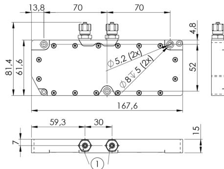
1 = For 4 mm tubing ID / 6 mm tubing OD
