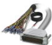
Konfektioniertes, geschirmtes Rundkabel; Anschluss 1: Einzeladern (50-polig) (Die Adern sind beschriftet und mit Aderendhülsen versehen. Das Schirmgeflecht ist auf ein separates Kabelende herausgeführt.); Anschluss 2: D-SUB-Stiftleiste (1x 50-polig); Kabellänge: variabel
