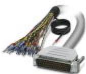
Konfektioniertes, geschirmtes Rundkabel; Anschluss 1: Einzeladern (50-polig) (Die Adern sind beschriftet und mit Aderendhülsen versehen. Das Schirmgeflecht ist auf ein separates Kabelende herausgeführt.); Anschluss 2: D-SUB-Stiftleiste (1x 50-polig); Kabellänge: 4 m
