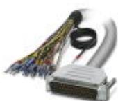
Konfektioniertes, geschirmtes Rundkabel; Anschluss 1: Einzeladern (50-polig) (Die Adern sind beschriftet und mit Aderendhülsen versehen. Das Schirmgeflecht ist auf ein separates Kabelende herausgeführt.); Anschluss 2: D-SUB-Stiftleiste (1x 50-polig); Kabellänge: 0,5 m
