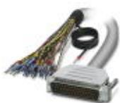
Konfektioniertes, geschirmtes Rundkabel; Anschluss 1: Einzeladern (50-polig) (Die Adern sind beschriftet und mit Aderendhülsen versehen. Das Schirmgeflecht ist auf ein separates Kabelende herausgeführt.); Anschluss 2: D-SUB-Stiftleiste (1x 50-polig); Kabellänge: 1,5 m
