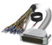
Konfektioniertes, geschirmtes Rundkabel; Anschluss 1: Einzeladern (50-polig) (Die Adern sind beschriftet und mit Aderendhülsen versehen. Das Schirmgeflecht ist auf ein separates Kabelende herausgeführt.); Anschluss 2: D-SUB-Stiftleiste (1x 50-polig); Kabellänge: 3 m
