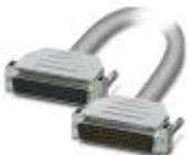
Konfektioniertes, geschirmtes Rundkabel; Anschluss 1: D-SUB-Buchsenleiste (1x 50-polig); Anschluss 2: D-SUB-Stiftleiste (1x 50-polig); Kabellänge: 6 m
