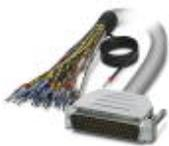
Konfektioniertes, geschirmtes Rundkabel; Anschluss 1: Einzeladern (50-polig) (Die Adern sind beschriftet und mit Aderendhülsen versehen. Das Schirmgeflecht ist auf ein separates Kabelende herausgeführt.); Anschluss 2: D-SUB-Stiftleiste (1x 50-polig); Kabellänge: 2 m
