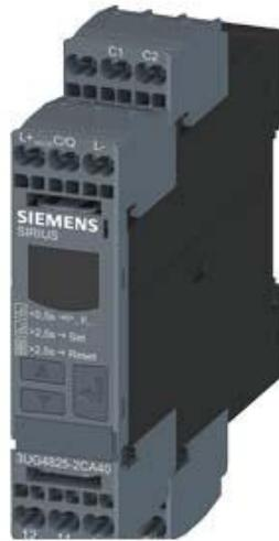
DIGITALES UEBERWACHUNGSRELAIS ZUR FEHLERSTROMUEBERWACHUNG (MIT DIFFERENZSTROMWAND. 3UL23) FUER IO-LINK EINSTELLBEREICH 0,03 A BIS 40 A GETRENNT FUER WARNSCHWELLE UND ABSCHALTWERT ANLAUF UND AUSLOESEVERZOEGERUNG 0 BIS 999,9S ABSCHALT-HYSTERESE BIS 50% WARN-HYSTERESE 5% FEST BREITE 22,5 MM, 2 WECHSLER MIT ODER OHNE FEHLERSPEICHER FEDERZUGTECHNIK
