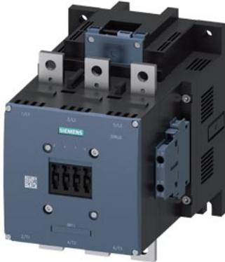
Leistungsschütz, AC-3e/AC-3 500 A, 250 kW / 400 V AC (50-60 Hz) / DC U<sub>c</sub>: 96-127 V SPS Eingang 24 V DC 3-polig, Hilfskontakte 2 S + 2 Ö Antrieb: elektronisch Hauptstr.: Schiene Steuer- und Hilfsstromkreis: Schraubanschluss
