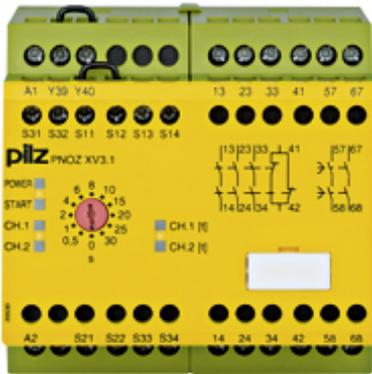
Sicherheitsschaltgerät (standalone), Eingänge: 1/2-kanalige Beschaltung mit/ohne Querschlusserkennung, Ausgänge: 3 S, 1 Ö, 2 Sz, UB = 24 V DC, Breite: 90 mm, Schraubklemmen integriert, Überwachung von Not-Halt, Schutztüren, mit 2 rückfallverzögerten Kontakten, Verzögerungszeit einstellbar in 12 Stufen von 0,1 - 30 s.
