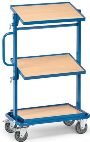
Stahlrohr- und Profilstahl-Konstruktion, pulverbeschichtet, blau RAL 5007. 3 Holzwerkstoffplatten, Rand 13 mm hoch. Obere und mittlere Etagen nach beiden Seiten um 15° und 30° neigbar. Arretierung mittels Federriegel. 2 Lenk- und 2 Bockrollen, TPE-Bereifung, Naben mit Rillenkugellager. Feststeller an den Lenkrollen, gemäß der Europäischen Norm EN 1757-3 (Sicherheit von Plattformwagen). Tragkraft obere und mittlere Ladefläche 50 kg.
