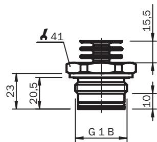
Gehäuse mit Kabelausgang
