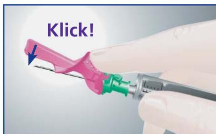
**6 Die geriffelte, ergonomisch geformte Griffplatte** verhindert ein Abrutschen des Daumens bzw. Zeigefingers beim Aktivieren des Sicherheitsmechanismus.
