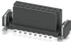
SMD-Federleiste, Nennstrom: 2,2 A, Prüfspannung: 840 V AC, Polzahl: 16, Rastermaß: 1,27 mm, Farbe: schwarz, Kontaktoberfläche: Gold, Kontaktart: Buchse, Montage: SMD-Löten
