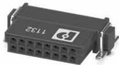
SMD-Federleiste, Nennstrom: 2,2 A, Prüfspannung: 500 V AC, Polzahl: 16, Rastermaß: 1,27 mm, Farbe: schwarz, Kontaktoberfläche: Gold, Kontaktart: Buchse, Montage: SMD-Löten
