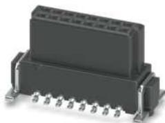
SMD-Federleiste, Nennstrom: 2,1 A, Prüfspannung: 840 V AC, Polzahl: 16, Rastermaß: 1,27 mm, Farbe: schwarz, Kontaktoberfläche: Gold, Kontaktart: Buchse, Montage: SMD-Löten
