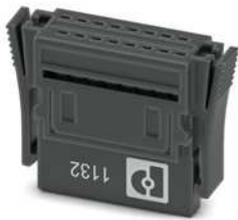
IDC-Federleiste, Nennstrom: 1,4 A, Prüfspannung: 500 V AC, Polzahl: 16, Rastermaß: 1,27 mm, Farbe: schwarz, Kontaktoberfläche: Gold, Kontaktart: Buchse
