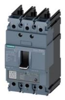
Leistungsschalter 3VA5 UL Frame 125 Schaltvermögenklasse H 65kA @ 480V 3-polig, Anlagenschutz TM230, FTAM, In=70A Überlastschutz Ir=70A fest eingestellt Kurzschlussschutz Ii=5...10 x In UL 489 SB (Naval), 50° C ohne Anschluss
