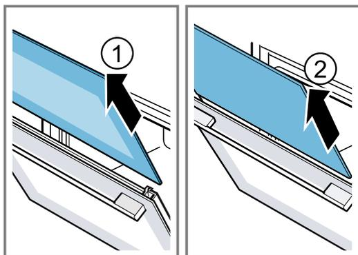
8. Die Gerätetür öffnen und Türdichtung abnehmen.
