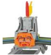
Die Prüfsteckerleisten lassen sich zum Prüfvorgang – auch bei angeschlossenen Leitern – auf die Klemmenleiste auf-schnappen. Da die Kontaktierung per Tippkontakt an den CAGE CLAMP®-Anschluss aus Federstahl erfolgt, bleibt diese Prüfart auf einen Nennstrom bis maximal 0,5 A beschränkt.
