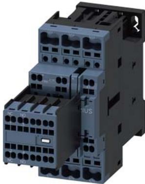
Leistungsschütz, AC-3e/AC-3, 25 A, 11 kW / 400 V, 3-polig, AC 230 V, 50 Hz, Hilfskontakte: 2 S + 2 Ö, Federzuganschluss, Baugröße: S0, Hilfsschalter lösbar
