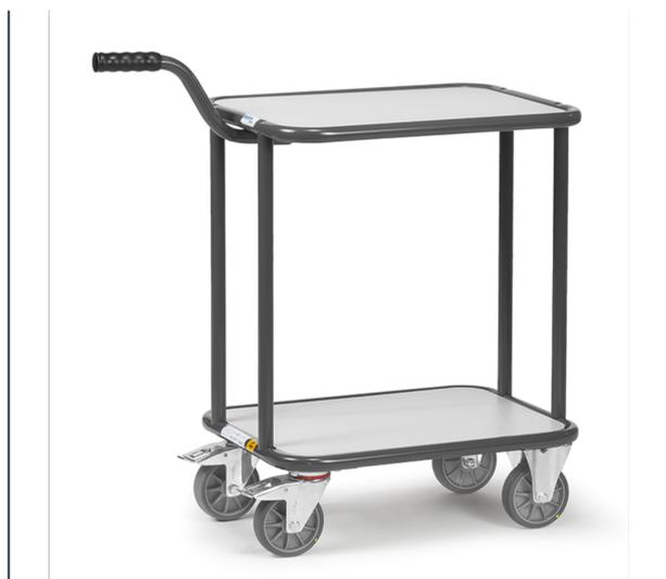
En tube d'acier soudé, poignée à boulonner. Revêtement époxy conducteur d'électricité gris ardoise RAL 7015. Plateaux en mélaminé conducteurs d'électricité conformément à la Norme 68765, gris clair. 2 roues pivotantes et 2 roues fixes à bandage TPE-ESD, conductrices d'électricité, moyeu à roulement à bille central. Freins sur roues pivotantes conformément à la Norme 1757-3 (Sécurité des chariots de manutention). Charge plateau du haut 100 kg.
