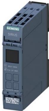
Digital einstellbares Überwachungsrelais Phasenausfall-, Phasenfolge-, Asymmetrie-, Frequenz-, Über- und Unterspannungsüberwachung für IO-Link 3x 90-690 V AC, 15-70 Hz 2 Wechsler Federzuganschluss
