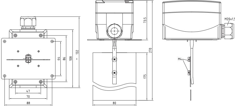
Mechanischer Windfahnenenschalter RHEASREG® WFS, Paddelschalter, Strömungsfühler oder Windfahnenrelais.
