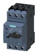
Leistungsschalter Baugröße S0 für den Motorschutz, CLASS 10 A-Auslöser 14...20 A N-Auslöser 260 A Schraubanschluss Schaltvermögen 30 kA bei 600 V nach UL/CSA
