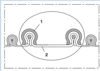
Tuyau PVC avec profilé de serrage (tuyau clippé), tenant jusque 110°C
