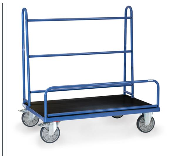
Ensemble mécano-soudé, revêtement époxy bleu RAL 5007. Plateforme en mélaminé surface avec revêtement caoutchouc. Armature en tôle d'acier à boulonner. 2 roues fixes et 2 roues pivotantes à bandage TPE, moyeu à roulement à billes. Freins sur roues pivotantes. Hauteur utile : 1 050 mm. Hauteur du tube cintré d'arrêt : 300 mm.
