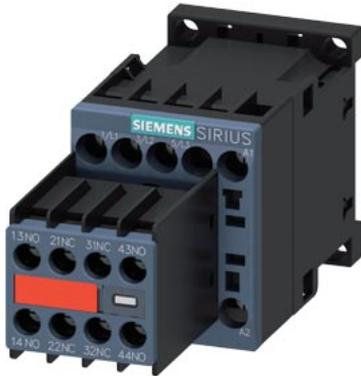
Leistungsschütz, AC-3e/AC-3, 16 A, 7,5 kW / 400 V, 3-polig, AC 230 V, 50/60 Hz, Hilfskontakte: 2 S + 2 Ö, Schraubanschluss, Baugröße: S00, Hilfsschalter unlösbar
