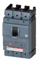
Leistungsschalter 3VA5 UL Frame 400 Schaltvermögenklasse M 35kA @ 480 V 3polig, Anlagenschutz TM240, ATAM, In=200A Überlastschutz Ir=160A ...200A Kurzschlussschutz Ii=5...10 x In ohne Anschluss
