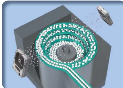
Abbau statischer Elektrizität von Zuführungseinrichtungen Verhindert Verstopfen.
