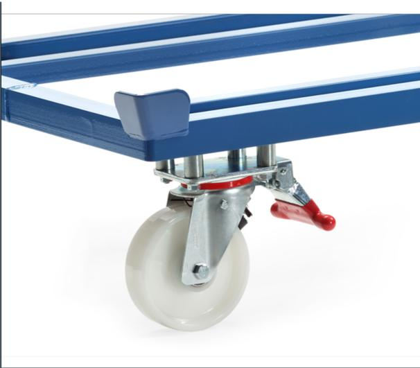
Mehrpreis für 2 Lenkrollen mit feststehendem Feststeller-Betätigungshebel unter dem Rahmen für Routenzug-Trolleys. Nicht überstehend. Anstatt der Lenkrollen mit mitschwenkendem Betätigungshebel. Von der Längsseite zu bedienen. Gute Erreichbarkeit in jeder Rollenposition. Unterfahrhöhe erhöht sich auf 237 mm, Gesamthöhe auf 282 mm.
