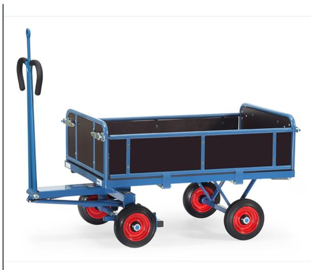
Ensemble mécano-soudé, revêtement époxy bleu RAL 5007. 4 inserts dans les angles, essieu sur rond à billes, timon en triangle avec poignée avec revêtement en plastique sécurisée remontant automatiquement en position verticale. Avec oeillet de traction, Ø interne 32 mm. Plateau en contreplaqué avec revêtement antidérapant et hydrofuge. Roues à bandage caoutchouc, moyeu à roulement à rouleaux. Freinage automatique sur essieu avant conformément à la Norme 1757-3.
