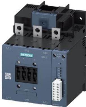
Leistungsschütz, AC-3e/AC-3 115 A, 55 kW / 400 V, AC (50-60 Hz) / DC Uc: 200-277 V SPS Eingang 24 V DC 3-polig, Hilfskontakte 1 S + 1 Ö Antrieb: elektronisch Hauptstr.: Schiene Steuer- und Hilfsstromkreis: Schraubanschluss, Restlebensdauermeldung
